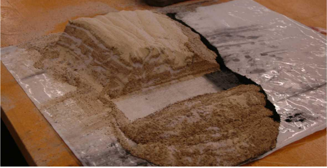
Şekil 1: Kum kutusunda oluşturulan kıvrım ve bindirme kuşağı. Kama, Canadian Rockies'de gözlenen klasik ince derili kıvrım ve bindirme deformasyon şeklini ortaya çıkaracak şekilde kesilmiştir.
